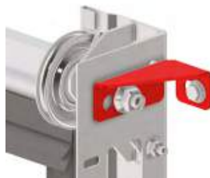
Установка кронштейна шкива на угловую стойку гаражных ворот серии Prestige
